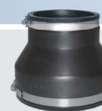
\*) материал: Универсальные соединительные элементы и универсальные переходники из высококачественного озоностойкого EPDM-эластомера (этилен–пропилен–диен–каучука). Стяжные хомуты из аустенитной нержавеющей высококачественной стали (1.4301, V2A). Химическая стойкость: следует избегать контакта с бензином, условными маслами (топливом) или растворителями. Высокая устойчивость к кислотам и щелочам. Подходит для прокладок в грунте. UV-светостойкие. Температуростойкость: от -40°C до +120°C.
