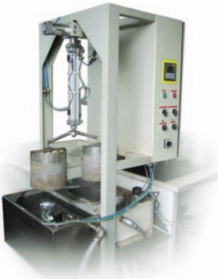
Resim: Sıcaklık değişmesi testi
