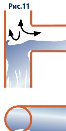
Установлено, что для функционирования напорного трубопровода необходимы существенные воздушные объемные потоки. Так, например, в напорном трубопроводе DN 100 при нагрузке сточными водами 100 л/мин транспортируется одновременно в целом 2340 л/мин воздуха.
