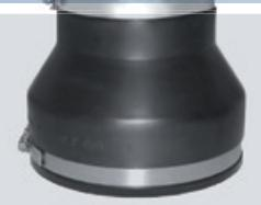
**\*) Materijal:** Univerzalne spojnice i univerzalne prijelazne spojnice izrađene su od visokokvalitetnog EPDM materijala. Zatezači su od nehrdajućeg čelika (1.4301,V2A). Kemijska otpornost: Izbjegavati dodir sa benzinom, uljem ili otapalama. Dobra otpornost na kiselinu i lužinu. Prikladno za podzemnu ugradnju. Otporno na UV-zrake. Temperaturna otpornost: između -40 °C do +120 °C.
